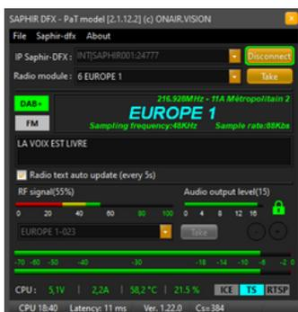
L'équipement se pilote à distance par l'application "SaphirDFXManager" afin de programmer les 9 radios de façon indépendante et d'écouter le programme sélectionné.
