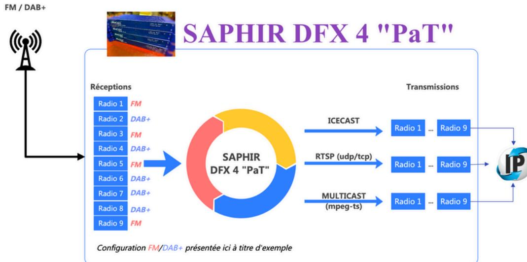
La très grande sensibilité des récepteurs et sa connectivité IP permet au **SAPHIR-DFX 4 "PaT"** d'être installé dans n'importe quel zone à contrôler équipée d'une antenne peu encombrante et d'une liaison ADSL grand public ou 4/5G pour transmettre les flux audio sur IP.
