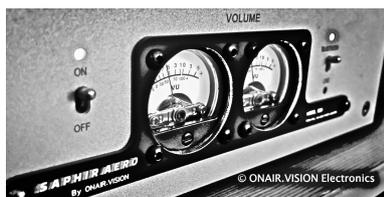
Les vumètres en façade indiquent le niveau de modulation de la source à l'écoute. Le bon niveau est celui qui joue **autour de 0 Vu**. Ajustez votre source pour rester dans ce gabarit.
